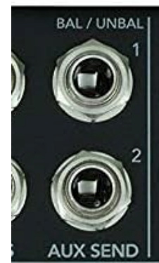
AUX-utgångar som är impedansbalanserade. Både balanserade och obalanserade kablar kan användas.
