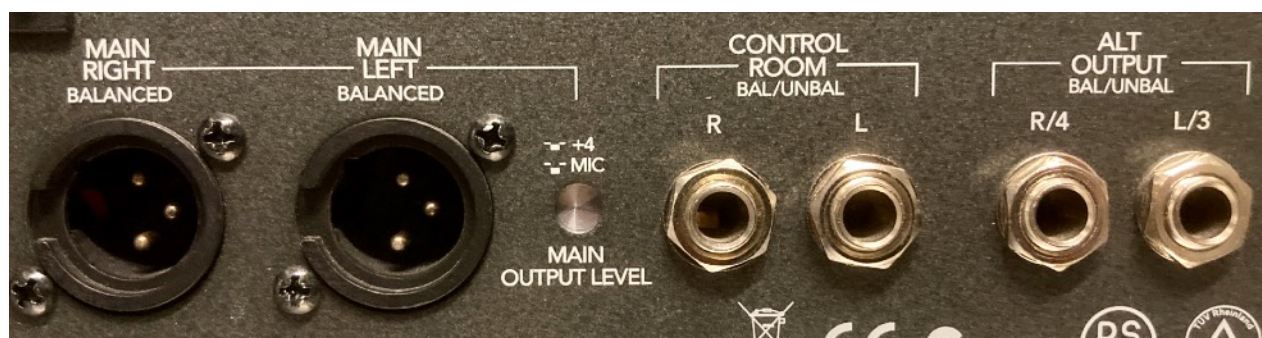
Balanserade XLR-utgångar och impedansbalanserade teleutgångar på en mixer
